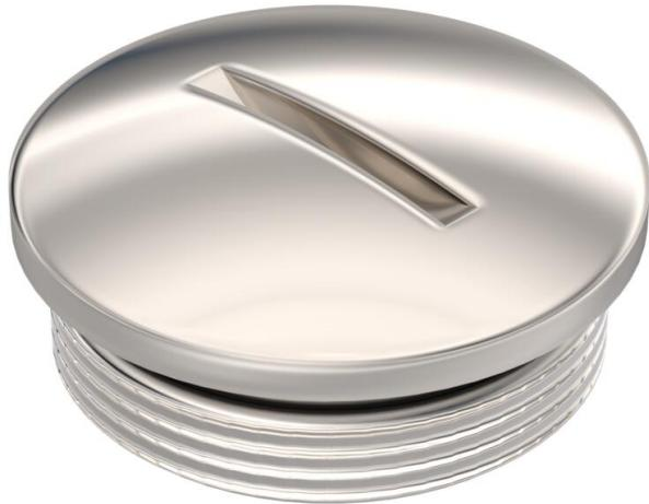
Verschlusschraube aus Metall mit integriertem Dichtring. Zum Verschließen von nicht genutzten Gewindeöffnungen z. B. in Gehäusen oder Abzweigdosen. Mit metrischem Gewinde nach DIN EN 60423 oder ISO 68. Schutzart IP 68 (5 bar/1 h).
