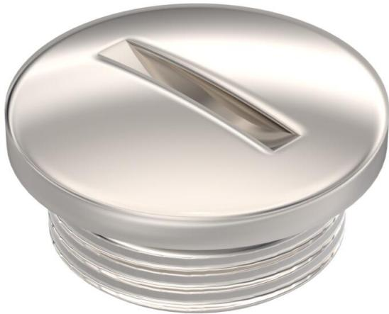
Verschlusschraube aus Metall mit integriertem Dichtring. Zum Verschließen von nicht genutzten Gewindeöffnungen z. B. in Gehäusen oder Abzweigdosen. Mit metrischem Gewinde nach DIN EN 60423 oder ISO 68. Schutzart IP 68 (5 bar/1 h).
