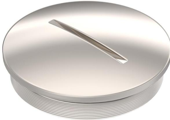
Verschlusschraube aus Metall mit integriertem Dichtring. Zum Verschließen von nicht genutzten Gewindeöffnungen z. B. in Gehäusen oder Abzweigdosen. Mit PG-Gewinde nach DIN EN 46320 oder DIN 40430. Schutzart IP 68 (5 bar/1 h).
