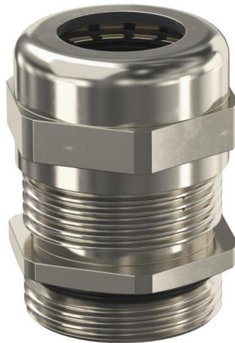
Robuste Kabelverschraubung mit metrischem Anschlussgewinde nach IEC 423 in Hutmutterbauart für hohe Dichtigkeitsansprüche. Zugentlastung, Verdrehschutz und Dichtigkeit über den gesamten Spannbereich. Dichtring aus Neopren. Klemmeinsatz aus Polyamid. Mit vormontiertem Dichtring am Anschlussgewinde, VDE-geprüft nach DIN EN 50262, Schutzart IP68 bei 5 bar/1h, Temperaturereinsatzbereich -20 bis +100°C.
