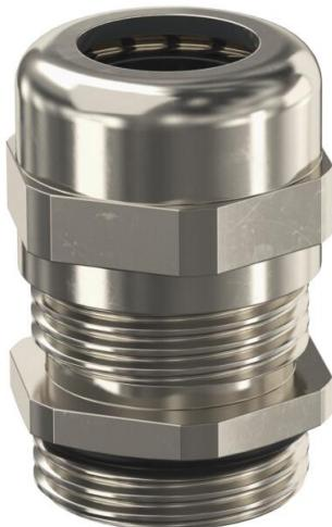
Robuste Kabelverschraubung mit metrischem Anschlussgewinde nach IEC 423 in Hutmutterbauart für hohe Dichtigkeitsansprüche. Zugentlastung, Verdrehschutz und Dichtigkeit über den gesamten Spannbereich. Dichtring aus Neopren. Klemmeinsatz aus Polyamid. Mit vormontiertem Dichtring am Anschlussgewinde, VDE-geprüft nach DIN EN 50262, Schutzart IP68 bei 5 bar/1h, Temperaturereinsatzbereich -20 bis +100°C.
