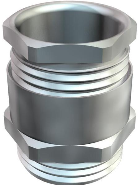
Kabelverschraubung mit Sechskant-Zwischenstutzen, Form C4 nach DIN 46320 mit PG-Anschlussgewinde nach DIN 40430. Druckringe Stahl, galvanisch verzinkt und transparent passiviert. Dichtring aus NR/SBR. Schutzart: mit Anschlussgewinde-Dichtring IP65, ohne Anschlussgewinde-Dichtring IP54. Mit Einschnittring. \* Preise laut DEL-Notierung.
