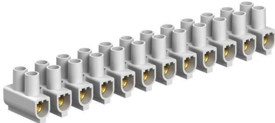
Geprüft nach EN 60998. Klemmen Messing, Schrauben Stahl, galvanisch verzinkt und transparent passiviert, 12-polige, in Einzelklemmen abtrennbare Leisten. Schrauben hochgedreht, unverlierbar. Max. zulässige Umgebungstemperatur gemäß EN 60998: -5 bis +80 °C. Nennquerschnitt 25  $\pm$  mm<sup>2</sup> Nennspannung 750 V Nennstrom 101 A Max. klemmbar je Seite: 25 mm<sup>2</sup> flexibel oder 16 mm<sup>2</sup> starr.
