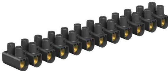
Geprüft nach EN 60998. Klemmen Stahl, Schrauben Stahl, galvanisch verzinkt, 12-polige, in Einzelklemmen abtrennbare Leisten durch "twist'n'pull". Schrauben hochgedreht, unverlierbar. Max. zulässige Umgebungstemperatur gemäß EN 60998: -5 bis +80 °C. Nennquerschnitt 16 ÷ mm<sup>2</sup> Nennspannung 450 V Nennstrom 76 A Max. klemmbar je Seite: 16 mm<sup>2</sup> starr oder 10 mm<sup>2</sup> flexibel bzw. 6 mm<sup>2</sup> flexibel.
