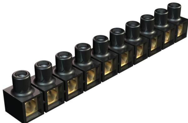
Klemmen Messing, Schrauben Stahl, galvanisch verzinkt und transparent passiviert, 10-polige, in Einzelklemmen abtrennbare Leiste, beidseitig offen. Schrauben hochgedreht, unverlierbar. Nennquerschnitt 10 ÷ mm<sup>2</sup> Nennspannung 380 V Max. anschließbare Querschnitte je Klemmstelle: 3 x 10 mm<sup>2</sup>, 4 x 6 mm<sup>2</sup>.
