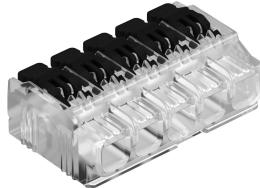
Schraubenlose Universal-Hebelsteckklemme zur Verbindung von elektrischen Leitern. Geeignet für flexible oder starre Leiter. Mit Lösehebel zum Einsticken und Herausziehen der Leiter. Starre Leiter können direkt eingesteckt werden. Abisolierlänge 11-12 mm. Prüffönnung an der Klemmenoberseite, zugänglich mit Phasenprüfer und Prüfstift (max. Ø 2 mm). Geprüft nach dem ENEC-Verfahren, das die Einhaltung der EN 60998 sichert und der VDE-Zertifizierung entspricht. Technische Daten UL (USA)
