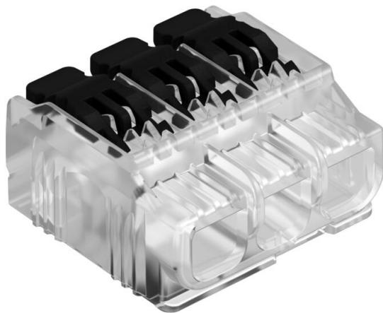
Schraubenlose Universal-Hebelsteckklemme zur Verbindung von elektrischen Leitern. Geeignet für flexible oder starre Leiter. Mit Lösehebel zum Einsticken und Herausziehen der Leiter. Starre Leiter können direkt eingesteckt werden. Abisolierlänge 11-12 mm. Prüffönnung an der Klemmenoberseite, zugänglich mit Phasenprüfer und Prüfstift (max. Ø 2 mm). Geprüft nach dem ENEC-Verfahren, das die Einhaltung der EN 60998 sichert und der VDE-Zertifizierung entspricht.
