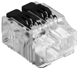
Schraubenlose Universal-Hebelsteckklemme zur Verbindung von elektrischen Leitern. Geeignet für flexible oder starre Leiter. Mit Lösehebel zum Einsticken und Herausziehen der Leiter. Starre Leiter können direkt eingesteckt werden. Abisolierlänge 11-12 mm. Prüffönnung an der Klemmenoberseite, zugänglich mit Phasenprüfer und Prüfstift (max. Ø 2 mm). Geprüft nach dem ENEC-Verfahren, das die Einhaltung der EN 60998 sichert und der VDE-Zertifizierung entspricht.
