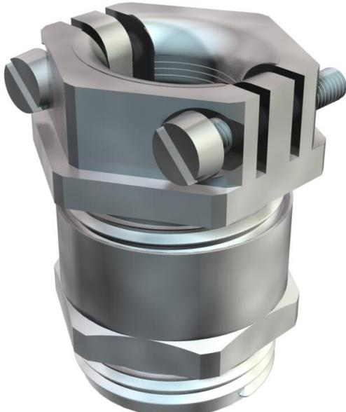
Kabelverschraubung mit zentrisch wirkender Querbügel-Zugentlastung in der Druckschraube, Biegeschutz beweglicher Leitungen durch stark gerundete Druckschraube. Mit PG-Anschlussgewinde nach DIN 40430. Druckringe Stahl, galvanisch verzinkt und transparent passiviert. Dichtring aus NR/SBR. Schutzart: mit Anschlussgewinde-Dichtring IP65, ohne Anschlussgewinde-Dichtring IP54. Mit Sechskant-Zwischenstützen (ähnlich Form C 4 nach DIN 46320). \* Preise laut DEL-Notierung.
