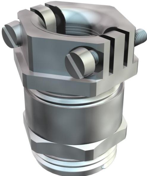
Kabelverschraubung mit zentrisch wirkender Querbügel-Zugentlastung in der Druckschraube, Biegeschutz beweglicher Leitungen durch stark gerundete Druckschraube. Mit PG-Anschlussgewinde nach DIN 40430. Druckringe Stahl, galvanisch verzinkt und transparent passiviert. Dichtring aus NR/SBR. Schutzart: mit Anschlussgewinde-Dichtring IP65, ohne Anschlussgewinde-Dichtring IP54. Mit Sechskant-Zwischenstützen (ähnlich Form C 4 nach DIN 46320). \* Preise laut DEL-Notierung.
