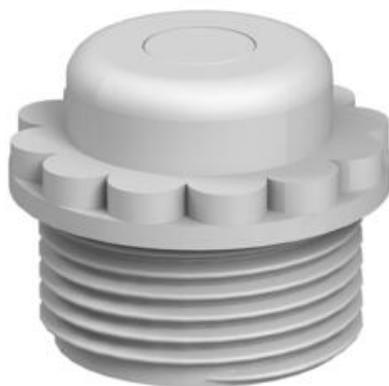
Mit Durchstoßmembranen, hierbei ist die Öffnung D vorgeprägt, aber zunächst verschlossen. Würgedichtung zum Einschrauben in metrische Gewinde nach IEC 423. Mit selbstdichtendem Konus am Gewindeende, daher kein Anschlussgewindedichtring erforderlich. Erreichbare Schutzart bei sorgfältiger Montage IP54.
