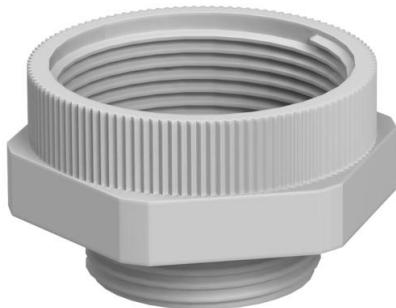
Erweiterung mit metrischem Innen- und Außengewinde für die Montage von Kunststoff-Kabelverschraubungen an Gehäusen. Schutzart IP54 ohne zusätzliche Anschlussdichtung. Schutzart bis IP68 möglich mit zusätzlicher Anschlussdichtung, zum Beispiel O-Ring oder Flachdichtring.
