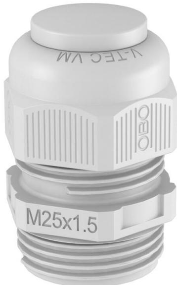
Kabelverschraubung mit metrischem Anschlussgewinde in Hutmutterbauart, für Kabelabzweigkästen, Gehäuse, Verteilerschränke im privaten und industriellen Bereich. Mit Zugentlastung und integrierter Dichtlippe, geprüft nach DIN EN 62444. Schutzklasse IP68. Einsetzbar von -20°C bis +65°C. Hiermit ist ein problemloses Verschließen nicht benötigter Öffnungen möglich. Es kann kein Staub oder Wasser eindringen und die Schutzart bleibt erhalten.
