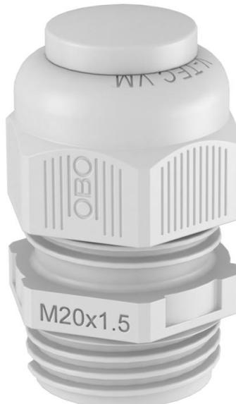
Kabelverschraubung mit metrischem Anschlussgewinde in Hutmutterbauart, für Kabelabzweigkästen, Gehäuse, Verteilerschränke im privaten und industriellen Bereich. Mit Zugentlastung und integrierter Dichtlippe, geprüft nach DIN EN 62444. Schutzklasse IP68. Einsetzbar von -20°C bis +65°C. Hiermit ist ein problemloses Verschließen nicht benötigter Öffnungen möglich. Es kann kein Staub oder Wasser eindringen und die Schutzart bleibt erhalten.
