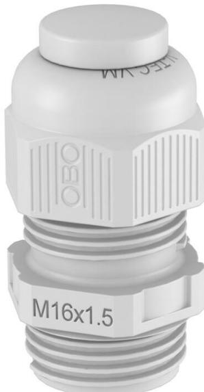
Kabelverschraubung mit metrischem Anschlussgewinde in Hutmutterbauart, für Kabelabzweigkästen, Gehäuse, Verteilerschränke im privaten und industriellen Bereich. Mit Zugentlastung und integrierter Dichtlippe, geprüft nach DIN EN 62444. Schutzklasse IP68. Einsetzbar von -20°C bis +65°C. Hiermit ist ein problemloses Verschließen nicht benötigter Öffnungen möglich. Es kann kein Staub oder Wasser eindringen und die Schutzart bleibt erhalten.
