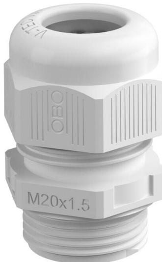
Kabelverschraubung mit metrischem Anschlussgewinde in Hutmutterbauart, für Kabelabzweigkästen, Gehäuse, Verteilerschränke im privaten und industriellen Bereich. Mit Zugentlastung und integrierter Dichtlippe, geprüft nach DIN EN 62444. Schutzklasse IP68. Einsetzbar von -20°C bis +65°C.
