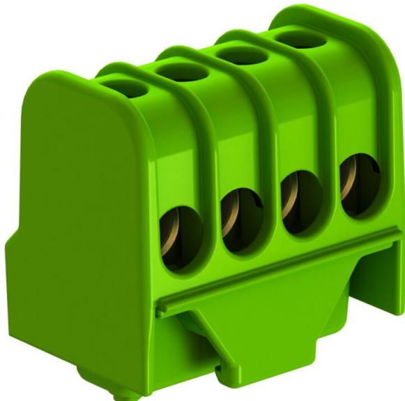
Schutzleiter- Anschlussklemme Klemmleiste aus Messing, Schrauben Stahl, galvanisch verzinkt und transparent passiviert, Nennquerschnitt 6 ÷ 16 mm<sup>2</sup>, Nennspannung 400 V, 1-polig, mit Buchsenklemmen max. anschließbare Leiter je Klemmstelle max. 4x16mm<sup>2</sup>, 4x10mm<sup>2</sup>, 8x6mm<sup>2</sup> oder 12x4mm<sup>2</sup>.
