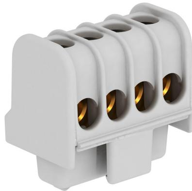
Klemmen Messing, Schrauben Stahl, galvanisch verzinkt und transparent passiviert, Nennquerschnitt 6 ÷ 16 mm<sup>2</sup>, Nennspannung 400 V, 1-polig, mit Buchsenklemmen max. anschließbare Leiter je Klemmstelle max. 4x16mm<sup>2</sup>, 4x10mm<sup>2</sup>, 8x6mm<sup>2</sup> oder 12x4mm<sup>2</sup>.
