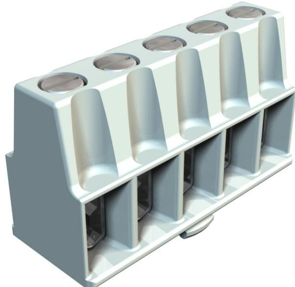
Klemmkörper und Schrauben aus Stahl, galvanisch verzinkt und transparent passiviert, Nennquerschnitt 1,5 ÷ 6 mm<sup>2</sup>, Nennspannung 400 V, 5-polig, mit Buchsenklemmen max. anschließbare Querschnitte je Klemmstelle: 3x6mm<sup>2</sup>, 4x4mm<sup>2</sup> oder 6x2,5mm<sup>2</sup>.
