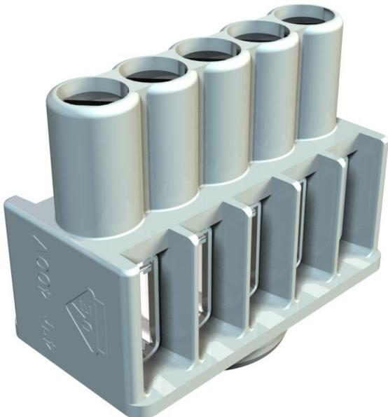
Klemmkörper und Schrauben aus Stahl, galvanisch verzinkt und transparent passiviert, Nennquerschnitt 1 ÷ 4 mm<sup>2</sup>, Nennspannung 400 V, 5-polig, mit Buchsenklemmen max. anschließbare Querschnitte je Klemmstelle max. 4x2,5mm<sup>2</sup>, 5x1,5mm<sup>2</sup> oder 6x1mm<sup>2</sup>.
