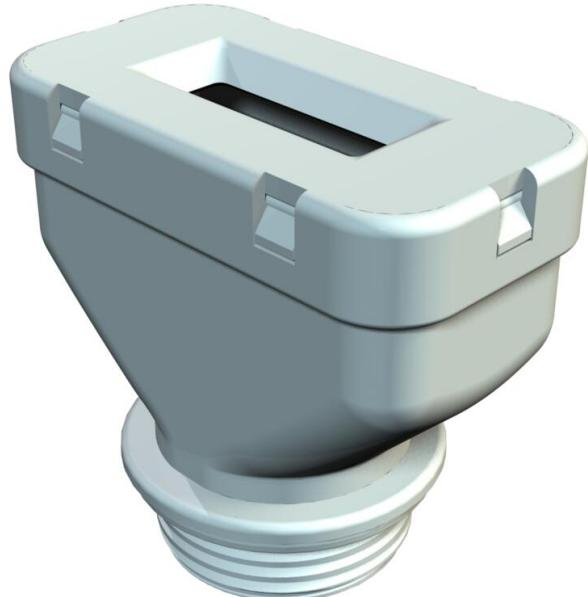
Flachkableinführung in Würgenippelbauart, mit metrischem Anschlussgewinde nach IEC 432, Schutzart IP31, mit vormontiertem Stutzendichtring 107/F.
