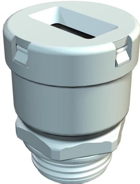
Flachkableinführung in Würgenippelbauart, mit metrischem Anschlussgewinde nach IEC 432, Schutzart IP 31, mit vormontiertem Stutzendichtring 107/F.
