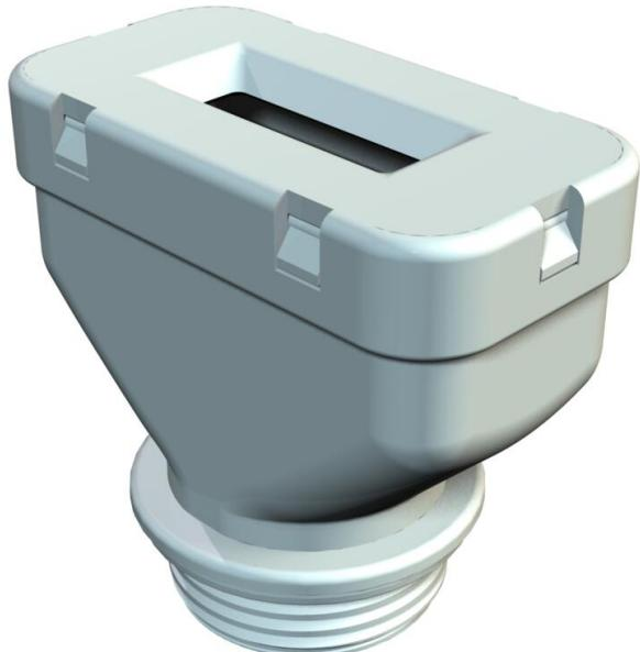
Flachkableinführung in Würgenippelbauart, mit PG-Anschlussgewinde nach DIN 40430, Schutzart IP31, mit vormontiertem Stutzendichtring 107/F.
