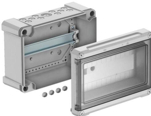
Kleinverteiler zur Aufputz-Montage, für die Strom-Unterverteilung im Innen- und Außenbereich, gemäß IEC 439-3. Mit vormontierter 35-mm-Hutprofilschiene. Schutzart IP66 und Schutzgrad IK08. Transparenter Deckel zum Schrauben, mit Ausschnitt. Inklusive 4 Schraubenabdeckkappen.
