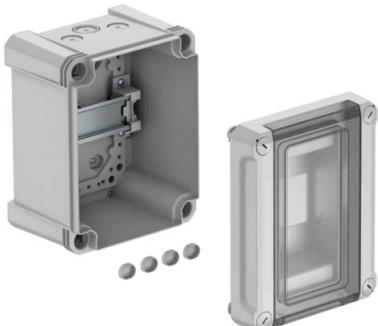
Kleinverteiler zur Aufputz-Montage, für die Strom-Unterverteilung im Innen- und Außenbereich, gemäß IEC 439-3. Mit vormontierter 35-mm-Hutprofilschiene. Schutzart IP66 und Schutzgrad IK08. Transparenter Deckel zum Schrauben, mit Ausschnitt. Inklusive 4 Schraubenabdeckkappen.
