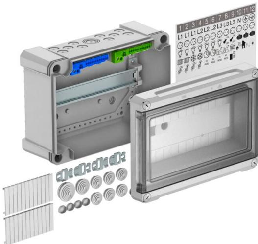
Kleinverteiler mit Klemmleiste zur Aufputz-Montage, für die Strom-Untervertei-lung im Innen- und Außenbereich, gemäß IEC 439-3. Mit vormontierter 35-mm-Hutprofilschiene. Schutzart IP66 und Schutzgrad IK08. Transparenter Deckel zum Schrauben, mit Ausschnitt.
