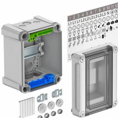
Kleinverteiler mit Klemmleiste zur Aufputz-Montage, für die Strom-Unterverteilung im Innen- und Außenbereich, gemäß IEC 439-3. Mit vormontierter 35-mm-Hutprofilschiene. Schutzart IP66 und Schutzgrad IK08. Transparenter Deckel zum Schrauben, mit Ausschnitt.
