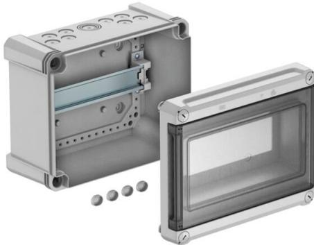
Kleinverteiler zur Aufputz-Montage, für die Strom-Untererteilung im Innen- und geschützten Außenbereich, gemäß IEC 439-3. Mit vormontierter 35-mm-Hutprofileschiene. Schutztart IP66 und Schutzgrad IK07. Transparenter Deckel zum Schrauben, mit Ausschnitt.
