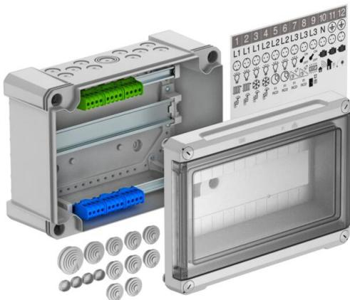
Kleinverteiler mit Klemmleiste zur Aufputz-Montage, für die Strom-Unterverteilung im Innen- und geschützten Außenbereich, gemäß IEC 439-3. Mit vormontierter 35-mm-Hutprofilschiene. Schutzart IP66 und Schutzgrad IK07. Transparenter Deckel zum Schrauben, mit Ausschnitt.
