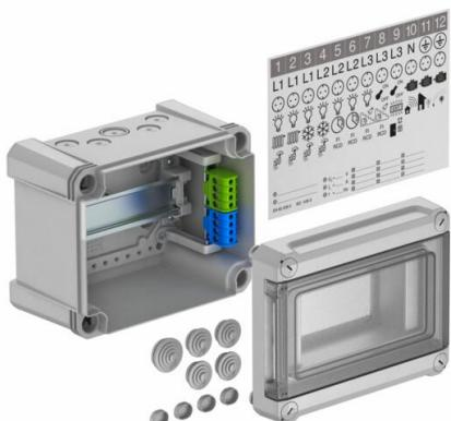
Kleinverteiler mit Klemmleiste zur Aufputz-Montage, für die Strom-Unterverteilung im Innen- und geschützten Außenbereich, gemäß IEC 439-3. Mit vormontierter 35-mm-Hutprofilschiene. Schutzart IP66 und Schutzgrad IK07. Transparenter Deckel zum Schrauben, mit Ausschnitt.
