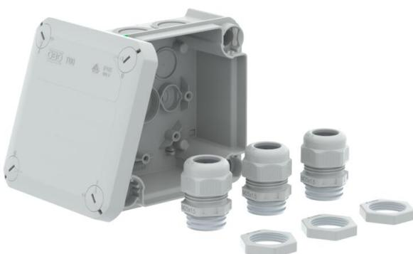
Kabelabzweigkasten zum Verbinden von Kabeln und Leitungen im Innenbereich und geschützten Außenbereichen. Quadratische Form mit Ausschlageinführungen an den Seiten und Ausschlageinführungen im Boden. Geeignet für die Wand-/ Deckenmontage und die Montage auf Montageblechen. Mit der Möglichkeit zur Innenbefestigung und Montage über die Eckdome. Deckel mit Schnellverschluss, plombierbar. Hergestellt aus halogenfreien und UV-resistenten Materialien.
