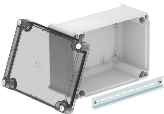
Kabelabzweigkasten geschlossen zum Verbinden von Kabeln und Leitungen im Innenbereich und geschützten Außenbereichen. Rechteckige Form ohne Einführungen. Geeignet für die Wand-/ Deckenmontage, die Montage auf Montageblechen und Gewinde im Boden. Mit der Möglichkeit zur Innenbefestigung und Montage über die Eckdome. Hoher, transparenter Deckel mit Schnellverschluss, plombierbar. Hergestellt aus halogenfreien Materialien.
