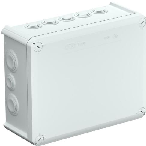
Kabelabzweigkasten zum Verbinden von Kabeln und Leitungen im Innenbereich und geschützten Außenbereichen. Rechteckige Form mit Einstechdichtungen an den Seiten und Ausschlägeöffnungen im Boden. Geeignet für die Wand-/ Deckenmontage, die Montage auf Montageblechen und Gewinde im Boden. Mit der Möglichkeit zur Innenbefestigung und Montage über die Eckdome. Deckel mit Schnellverschluss, plombierbar. Hergestellt aus halogenfreien Materialien.
