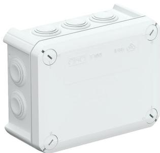
Kabelabzweigkasten zum Verbinden von Kabeln und Leitungen im Innenbereich und geschützten Außenbereichen. Rechteckige Form mit Einsteckdichtungen an den Seiten und Ausschlägeöffnungen im Boden. Geeignet für die Wand-/ Deckenmontage und die Montage auf Montageblechen. Mit der Möglichkeit zur Innenbefestigung und Montage über die Eckdome. Deckel mit Schnellverschluss, plombierbar. Hergestellt aus halogenfreien Materialien. Flammwidrige Ausführung aus speziellem Polypropylen.
