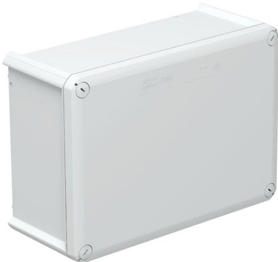
Kabelabzweigkasten geschlossen zum Verbinden von Kabeln und Leitungen im Innenbereich und geschützten Außenbereichen. Rechteckige Form ohne Einführungen. Geeignet für die Wand-/ Deckenmontage, die Montage auf Montageblechen und Gewinde im Boden. Mit der Möglichkeit zur Innenbefestigung und Montage über die Eckdome. Deckel mit Schnellverschluss, plombierbar. Hergestellt aus halogenfreien und UV-resistenten Materialien.
