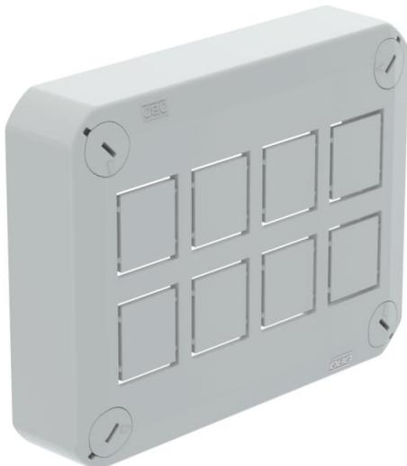
Steckbarer Deckel zum Verschließen von Kabelabzweigkästen, ausgestattet mit 8 Ausbrechöffnungen für DATA-Systeme auf Keystone-Basis. Mit Schnellverschluss im Deckel, plombierbar. Halogenfreies Material, UV-resistent. Flammwidrig nach DIN EN 60695-2-11, Prüftemperatur 650°C. Schlagfestigkeit IK07 bei Raumtemperatur. Schutzart IP30.
