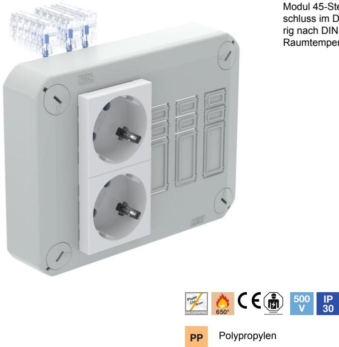
Steckbarer Deckel zum Verschließen von Kabelabzweigkästen, bestückt mit 2 Modul 45-Steckdosen, vorverdrahtet mit Hebelsteckklemmen. Mit Schnellverschluss im Deckel, plombierbar. Halogenfreies Material, UV-resistent. Flammwidrig nach DIN EN 60695-2-11, Prüftemperatur 650°C. Schlagfestigkeit IK07 bei Raumtemperatur. Schutzart IP30.
