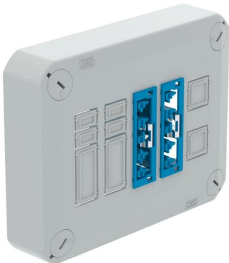
Steckbarer Deckel zum Verschließen von Kabelabzweigkästen, bestückt mit 2 Wago WINSTA MIDI Stecksystemen, vorverdrahtet mit Hebelsteckklemmen. Mit Schnellverschluss im Deckel, plombierbar. Halogenfreies Material, UV-resistent. Flammwidrig nach DIN EN 60695-2-11, Prüftemperatur 650°C. Schlagfestigkeit IK07 bei Raumtemperatur. Schutzart IP30.
