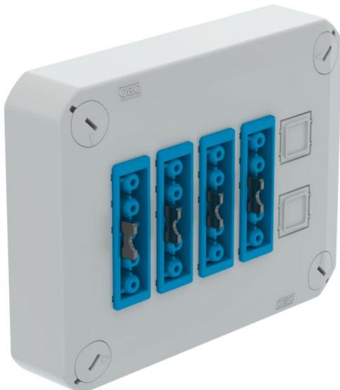
Steckbarer Deckel zum Verschließen von Kabelabzweigkästen, bestückt mit 4 Wieland GST18-Stecksystemen, vorverdrahtet mit Hebelsteckklemmen. Mit Schnellverschluss im Deckel, plombierbar. Halogenfreies Material, UV-resistent. Flammwidrig nach DIN EN 60695-2-11, Prüftemperatur 650°C. Schlagfestigkeit IK07 bei Raumtemperatur. Schutzart IP30.
