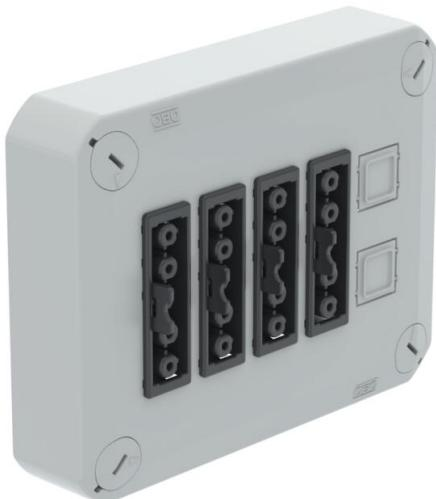
Steckbarer Deckel zum Verschließen von Kabelabzweigkästen, bestückt mit 4 Wieland GST18-Stecksystemen, vorverdrahtet mit Hebelsteckklemmen. Mit Schnellverschluss im Deckel, plombierbar. Halogenfreies Material, UV-resistent. Flammwidrig nach DIN EN 60695-2-11, Prüftemperatur 650°C. Schlagfestigkeit IK07 bei Raumtemperatur. Schutztart IP30.
