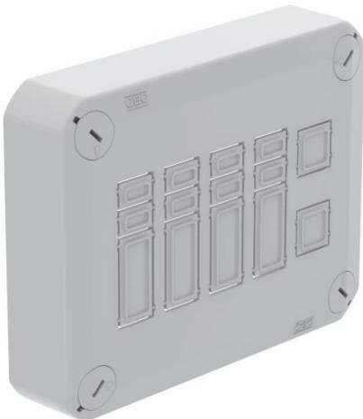
Steckbarer Deckel zum Verschließen von Kabelabzweigkästen, ausgestattet mit 6 Ausbrechöffnungen für Anschlussbuchsen von Wieland und Wago, 3- bis 5-polig. Mit Schnellverschluss im Deckel, plombierbar. Halogenfreies Material, UV-resistent. Flammwidrig nach DIN EN 60695-2-11, Prüftemperatur 650°C. Schlagfestigkeit IK07 bei Raumtemperatur. Schutzart IP30.
