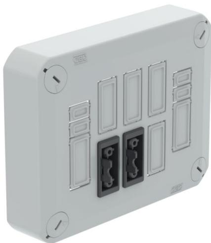
Steckbarer Deckel zum Verschließen von Kabelabzweigkästen, bestückt mit 2 Wieland GST18-Stecksystemen, vorverdrahtet mit Hebelsteckklemmen. Mit Schnellverschluss im Deckel, plombierbar. Halogenfreies Material, UV-resistent. Flammwidrig nach DIN EN 60695-2-11, Prüftemperatur 650°C. Schlagfestigkeit IK07 bei Raumtemperatur. Schutzart IP30.
