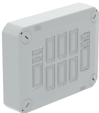
Steckbarer Deckel zum Verschließen von Kabelabzweigkästen, ausgestattet mit 8 Ausbrechöffnungen für Anschlussbuchsen von Wieland und Wago, 3- bis 5-polig. Mit Schnellverschluss im Deckel, plombierbar. Halogenfreies Material, UV-resistent. Flammwidrig nach DIN EN 60695-2-11, Prüftemperatur 650°C. Schlagfestigkeit IK07 bei Raumtemperatur. Schutzart IP30.
