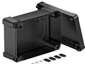
Kabelabzweigkasten zum Verbinden von Kabeln und Leitungen im Innen- und Außenbereich. Rechteckige Form ohne Einführungen. Geeignet für die Wand-/Deckenmontage mit der Möglichkeit zur Außenbefestigung, Innenbefestigung oder Montage über die Eckdome. Besonders schlagfest mit IK09. Deckel mit Schnellverschluss, plombierbar. Hergestellt aus halogenfreien und UV-resistenten Materialien.
