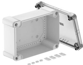
Kabelabzweigkasten zum Verbinden von Kabeln und Leitungen im Innen- und Außenbereich. Rechteckige Form ohne Einführungen. Geeignet für die Wand-/Deckenmontage mit der Möglichkeit zur Außenbefestigung, Innenbefestigung oder Montage über die Eckdome. Besonders schlagfest mit IK09. Transparenter Deckel mit Schnellverschluss, plombierbar. Hergestellt aus halogenfreien und UV-resistenten Materialien.
