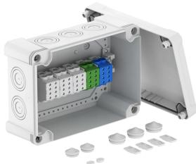
Kabelabzweigkasten zum Verbinden von Kabeln und Leitungen im Innen- und Außenbereich. Rechteckige Form mit Ausschlageinführungen. Geeignet für die Wand-/ Deckenmontage mit der Möglichkeit zur Außenbefestigung, Innenbefestigung oder Montage über die Eckdome. Besonders schlagfest mit IK08. Deckel mit Schnellverschluss, plombierbar. Hergestellt aus halogenfreien und UV-resistenten Materialien.
